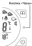
Рисунок 6. Переход в режим установки времени
