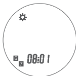
Рисунок 11. Индикация программирования 2-х периодов для выходных дней
