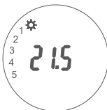
Рисунок 9. Установка температуры для периода времени
