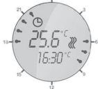
Рисунок 13. Пример индикации таймера, запрограммированного на 24 часа
