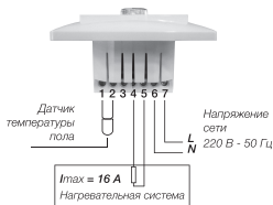
Рисунок 4. Схема подключения к терморегулятору
